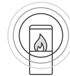
Le rayonnement est la chaleur dégagée directement par l'appareil. Ces rayons traversent l'air jusqu'à ce qu'ils atteignent une matière qui puisse les absorber. Ce matériau va alors commencer à chauffer. Ce type de chauffage est conseillé pour les pièces à hauts plafonds, pour les maisons exposées au vent ou difficiles à chauffer et les grands volumes.
