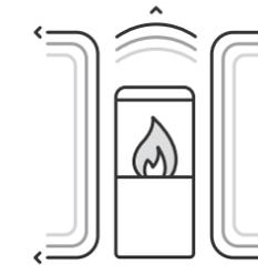
La chaleur par convection est créée lorsque l'air autour du poêle à bois devient chaud, se dilate et s'élève. Si le poêle à bois est doté d'un double de convection (plaques sur les côtés avec des ouvertures en haut et en bas), l'air canalisé s'élève et distribue la chaleur dans la pièce et au-delà. Un chauffage par convection convient bien pour chauffer plusieurs pièces entre lesquelles on peut organiser une circulation d'air.
