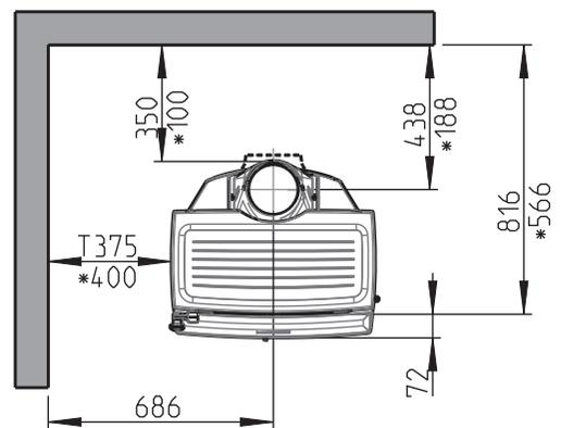
\*Avec un tuyau de fumée semi-isolé et un écran thermique supplémentaire
