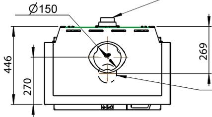
Trou dans le sol pour l'arrivée d'air extérieur  $\varnothing 80/\varnothing 100$
