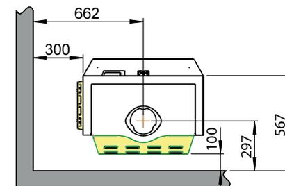
F 620 : Distance minimale par rapport à un mur inflammable protégé par une paroi ignifuge agréée
