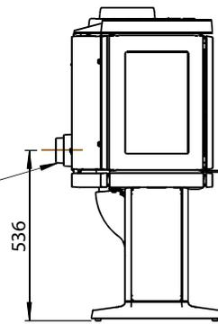
Trou dans le mur pour l'arrivée d'air extérieur  $\varnothing 80/\varnothing 100$
