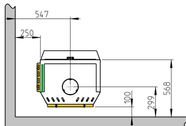
F 520 / F 520 LB / F 520 HT: Distance minimale par rapport à un mur inflammable protégé par une paroi ignifuge agréée
