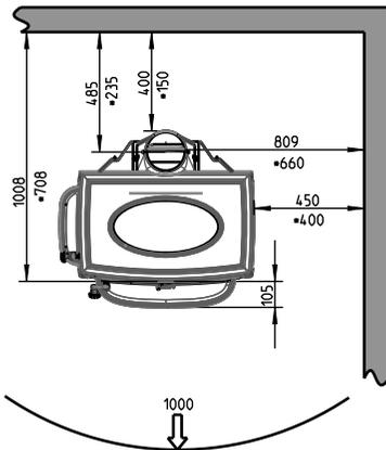
\* Avec d'écran thermique derrière et tuyau isolé
