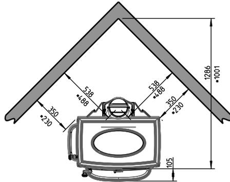
\* Avec d'écran thermique derrière et tuyau isolé
