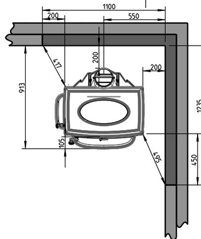
Distance minimale par rapport au mur en matériau combustible protégé par un pare-feu
